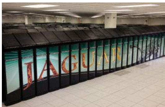
全球排名第二美國能源部國家實驗室的Cray XT5「Jaguar」超級電腦，即將升級系統的處理器，改用六核心Opteron。
